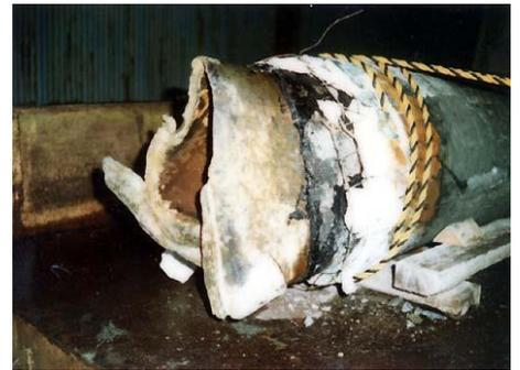
図-1 破損した海底送水管[1]
